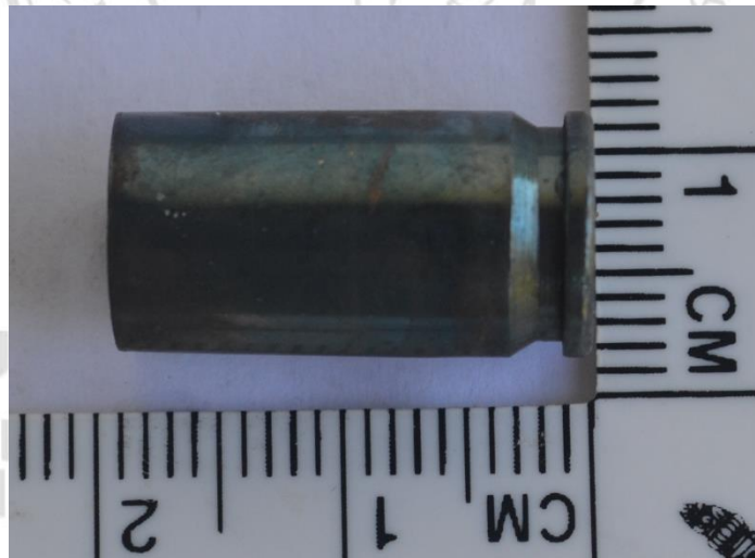
ภาพที่ 4.5 ปดอกระสุนปืนหลังอิงเมื่อนำมาทดสอบกับน้ำยารมดำปืน แล้วไม่ปรากฏรอยลายนิ้วมือแฝง
