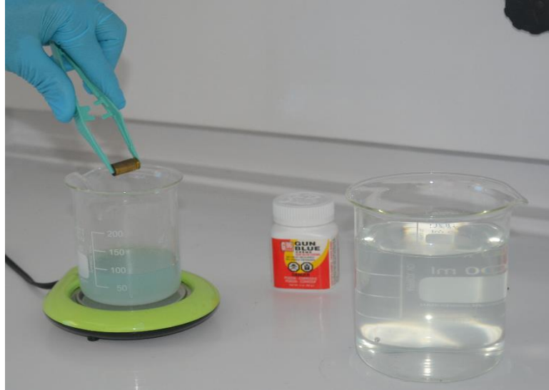
ภาพที่ 3.11 การทดลองหารอยลายนิ้วมือแฝงบนปลอกกระสุนปืนหลังยิงในห้วงเวลาต่าง ๆ
